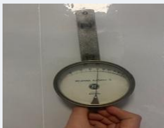
Analogni higrometar koji prikazuje relativnu vlažnost zraka
