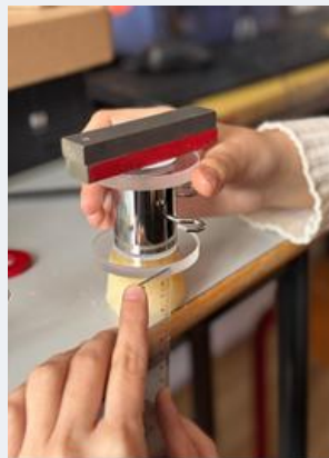
Mjerenje promjene visine želatina pod djelovanjem određene težine
