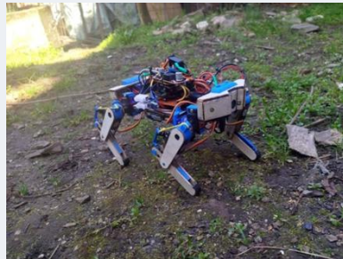
Testiranje stabilnosti kretanja na neravnom terenu i na betonu.
