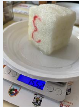
Vaganje zasićenog uzorka nakon potapanja
