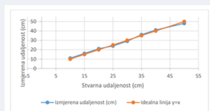
Grafički prikaz poređenja stvarne i izmjerene udaljenosti pomoću ultrazvučnog senzora
