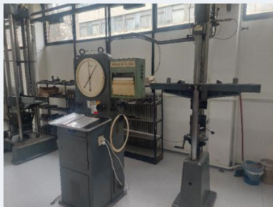
Univerzalna hidraulična kidalica u institutu "Kemal Kapetanović"
