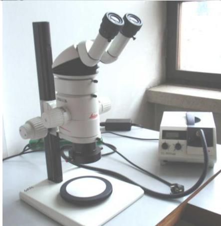
A white Leica stereo microscope with a digital camera attached, sitting on a desk next to a small electronic device. | Mikroskop s mogućnošću uvećanja od od 8 do 60x, sa DFC Twain softverom za PC Leica Image Manager IM50. Mogućnost identifikacije pukotina, poroznosti, kvaliteta površine,... |
