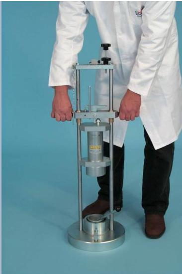
Ispitivanje otpornosti kamenog agregata na udar.
