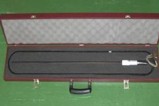
Etalon se koristi pri kalibraciji mjerila temperature-drugih otpornih termometara, termolemenata i dig.termometara sa sondama uz korištenje aparature za kalibraciju termoelemenata i drugih aparatura, te dodatne aparature pomoću koje se registruje
