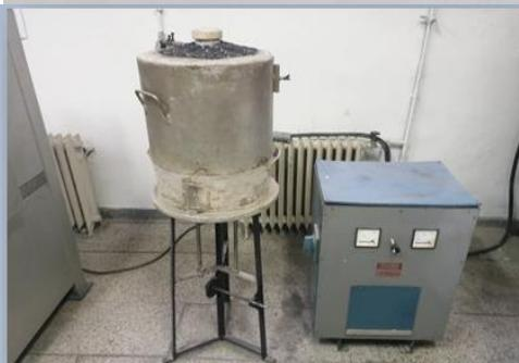
Koristi se za ispitivanje vatrostalnosti Mjerno područje do 1800°C
