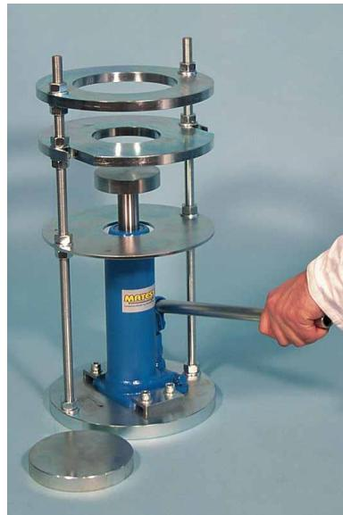
Priprema uzoraka asfalta za Marshallov test.
