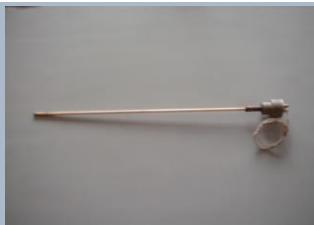
Etalon se koristi pri kalibraciji mjerila temperature-drugih termolemenata uz korištenje aparature za kalibraciju termoelemenata i drugih aparatura, te dodatne aparature pomoću koje se registruje napon termoelementa i isti se konvertira u temperaturu. Mjerno područje: 0 °C – 1200 °C
