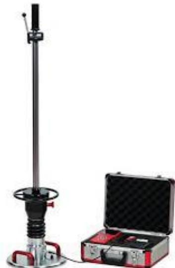
Ispitivanje stišljivosti zbijenih slojeva donjem strojima kolovoznih konstrukcija i tla.
