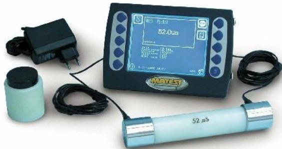
Ispitivanje brzine prolaska ultrazvuka i indirektnog određivanja dinamičkog modula elastičnosti (nedestruktivna metoda).
