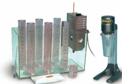
Ispitivanje granulometrijskog sastava finodisperznih materijala sedimentacionom metodom.
