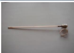
Etalon se koristi pri kalibraciji mjerila temperature-drugih termolemenata uz korištenje aparature za kalibraciju termoelemenata i drugih aparatura, te dodatne aparature pomoću koje se registruje napon termoelementa i isti se konvertira u temperaturu. Mjerno područje: 0 °C – 1600 °C
