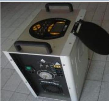
Oprema za mjerenje koncentracije čvrstih čestica (prahine) u dimnim plinovima koja se emituje iz izvora zagadživanja. Mjerni opseg protoka: 4-50 l/min; Senzor za apsolutni pritisak: opseg 0÷1035 kPa; Senzor za diferencijalni pritisak: opseg 0÷2500 (max 30 000 kPa); Senzor za temperaturu Termopar K: opseg 0 +1200 °C
