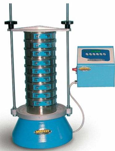
Ispitivanje granulometrijskog sastava agregata metodom suhog prosijavanja.
