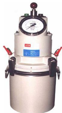
Ispitivanje sadržaja uvučenog zraka betona prema:
