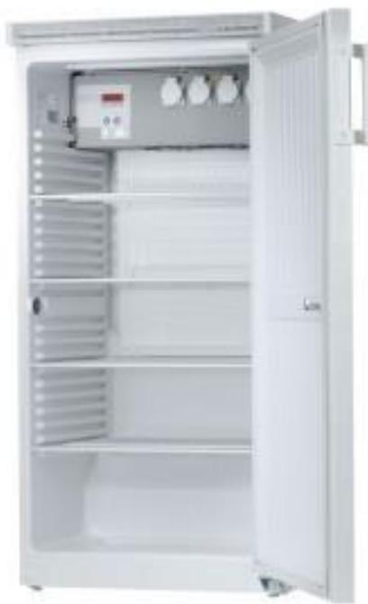
Raspon temperature: +2 - + 40 °C ( može i od + 3 ° - iznad +40 °C). Kapacitet: do 30 kg (da se može postaviti uređaj za BPK). Primjena: za BPK mjerjenja
