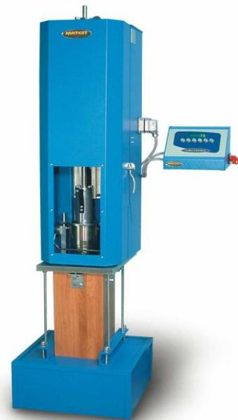
Priprema uzorka asfalta za Marshallov test.
