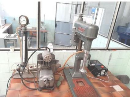
Flotiranje različitog materijala uz mogućnost promjene brzine okretanja impelera i propuhivanja zraka
