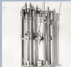
Ovo je etalonska aparatura za kalibraciju mjerila niskog pritiska i podpritiska. Mjerni opseg:
