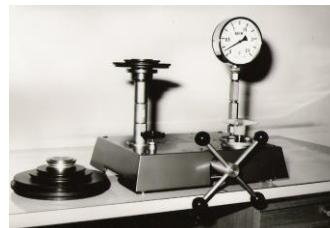
Aparatura se koristi za potrebe kalibriranja tekućinskih, rasteznih i ostalih termometara, mjernih krugova temperature i dr.tempearturnih sondi. Mjerno područje aparature je amb.temp – 250 °C
