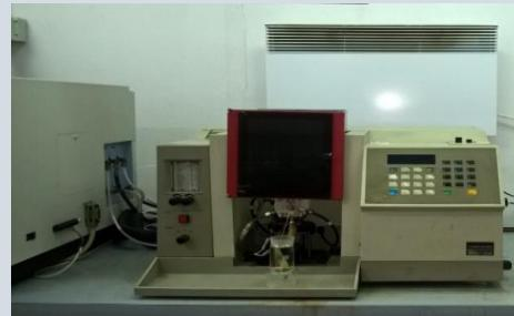
Određivanje sadržaja metala i metaloida;
