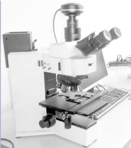
A white digital light microscope with a camera attached to the side, sitting on a desk next to a computer keyboard.   | Mikroskop s mogućnošću uvećanja od 50 do 1000x, sa ADS softverom za mikrostrukturnu analizu slike.                                                                           |
