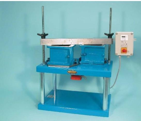
Koristi se za sabijanje laboratorijskih uzoraka betona. Izrađen je od čeličnog lima, opremljen motorom za vibriranje s 3000 vibracija u minuti. Ima mogućnost mijenjanja intenziteta vibracija .
