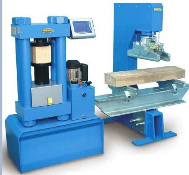
Ispitivanje čvrstoće na pritisak betona, kamena, opeke itd.
