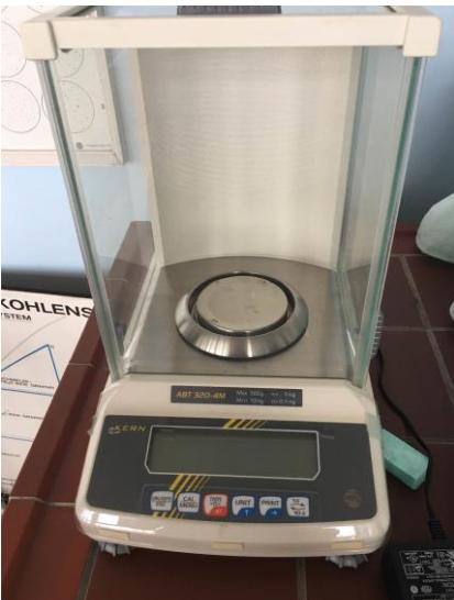
Mjerenje mase uzorka za STA uređaj u rasponu od od 10 mg do 320 g.
