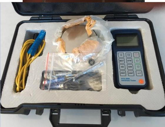
Terenski uređaj za mjerenje tvrdoće.
