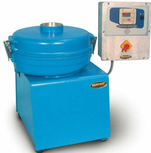
Ispitivanje sadržaja bitumena u asfaltu.
