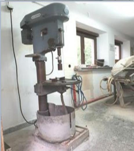
Koristi se za vađenje uzoraka za ispitivanje iz oblikovanih vratostalnih materijala
