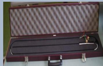
Etalon se koristi pri kalibraciji mjerila temperature-drugih otpornih termoemetera, termolemenata i dig.termoemetara sa sondama uz korištenje aparature za kalibraciju termoelemenata i drugih aparatura, te dodatne aparature pomoću koje se registruje otpor sa etalona i isti se konvertira u temperaturu. Mjerno područje:
