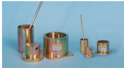
Ispitivanje otpornosti kamenog agregata prema drobljenju u cilindru.
