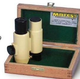
Utvrđivanje prisustva i dimenzija pora i pukotina u uzorcima kamena, betona, opeke itd.)
