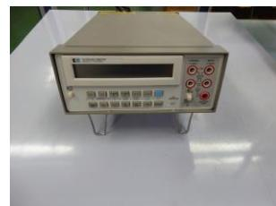
Ovo je etalonska aparatura za kalibraciju otpornih termometara i termolemenata a služi u svrhu mjerena otpora i napona. Mjerni opseg:
