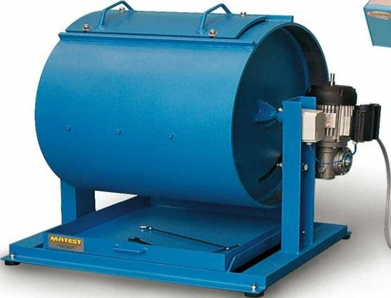
Ispitivanje otpornosti kamenog agregata na drobljenje metodom Los Angeles.
