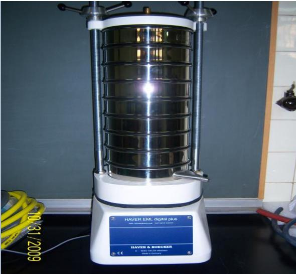
Ispitivanje granulometrijskog sastava agregata metodom mokrog prosijavanja.
