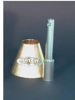
Ispitivanje stanja vlažnosti sitnog agregata (0-4mm)
