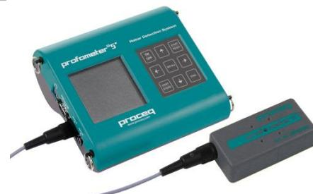
Određivanje pozicija armature u betonskim konstrukcijama
