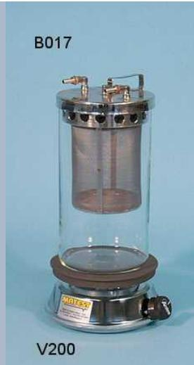
Ispitivanje sadržaja bitumena u asfaltu.
